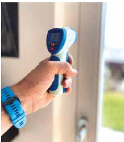
Der digitale Infrarot-Thermometer erfasst die thermische Strahlung eines Objekts und errechnet daraus dessen Temperatur.
