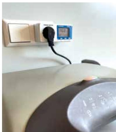
Das Energiekostenmessgerät zeigt den Stromverbrauch einzelner Geräte an.
