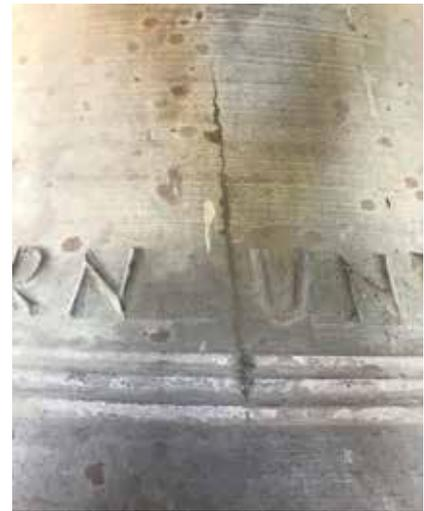
Der rund 30 cm lange vertikale Sprung an der Außenseite der Glocke
